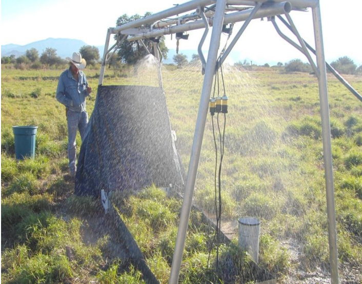
Figura 4. Simulador de lluvia sobre terreno con zacate buffel.
