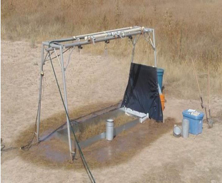
Figura 2. Simulador de lluvia en operación sobre parcela de escurrimiento.
